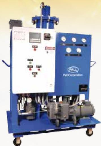
► Purificación de aceites en centrales hidráulicas y de turbogeneración mediante sistema de termovacío.
