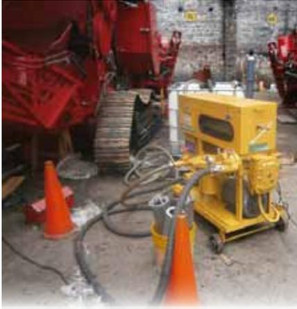
Mantenimiento y limpieza técnica por sistema de filtro prensado y recirculación a tanques de maquinaria agrícola.
