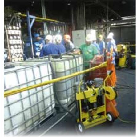
Conteo de partículas y humedad en línea en procesos de dialización de aceites y flushing en sistemas hidráulicos.
