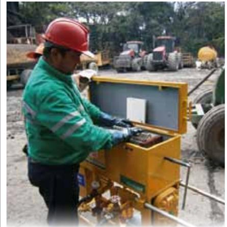
Recambio de elementos filtrantes en operaciones de limpieza de tanques por sistema de filtro prensado.
